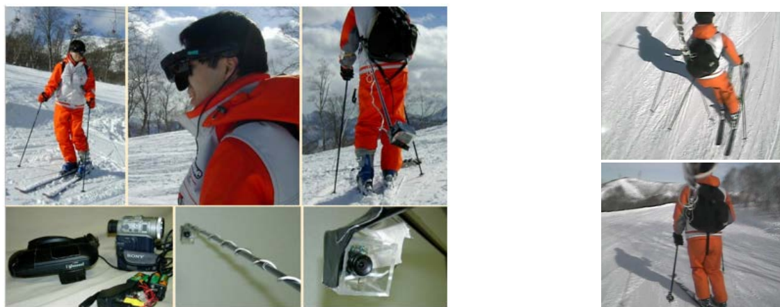
図 1 HMD とカメラによる第三者視点映像提示装置 (左) と滑走中に提示される映像 (右)
