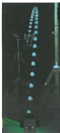
ナックルボールの飛翔のストロボ映像(30分の1秒毎)
