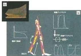
身体運動の3次元シミュレーション。文献(12)より引用。下腿骨格モデルに関節可動域を指定する受動トルクを入力。それぞれの筋に力-長さ関係(FL)・力-速度関係(FV)の特性を与え、更に腱の弾性も考慮に入れた。筋を活動させ(刺激ダイナミクス)、最適化を行うことで歩行あるいは垂直跳をシミュレートする。(a)歩行。(b)垂直跳。
